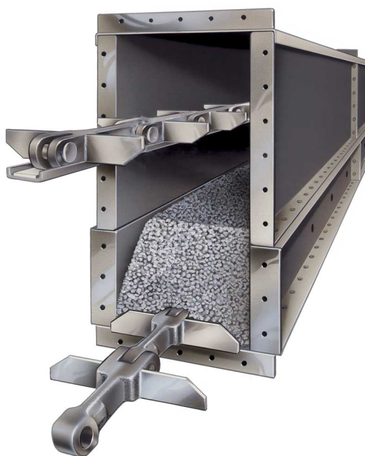
Figuur 1.4 Een redler voor horizontaal transport (Bron: batemanengineering.com [5])
