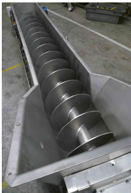
Figuur 1.6 Een schroeftransport (Bron: conmaxengg.com [8])
