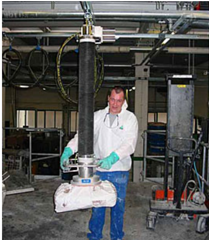
Figuur 7.1 Een hulpmiddel voor het hanteren van zakgoed (van http://nl.schmalz.com/ [43])
